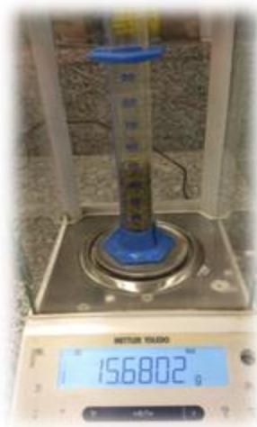
**Figura 5:** Imagen de la metodología empleada para la determinación de la densidad aparente
