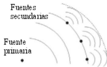
Figura 2.34. Reconstrucción del frente de onda por medio de *wavelets*.
