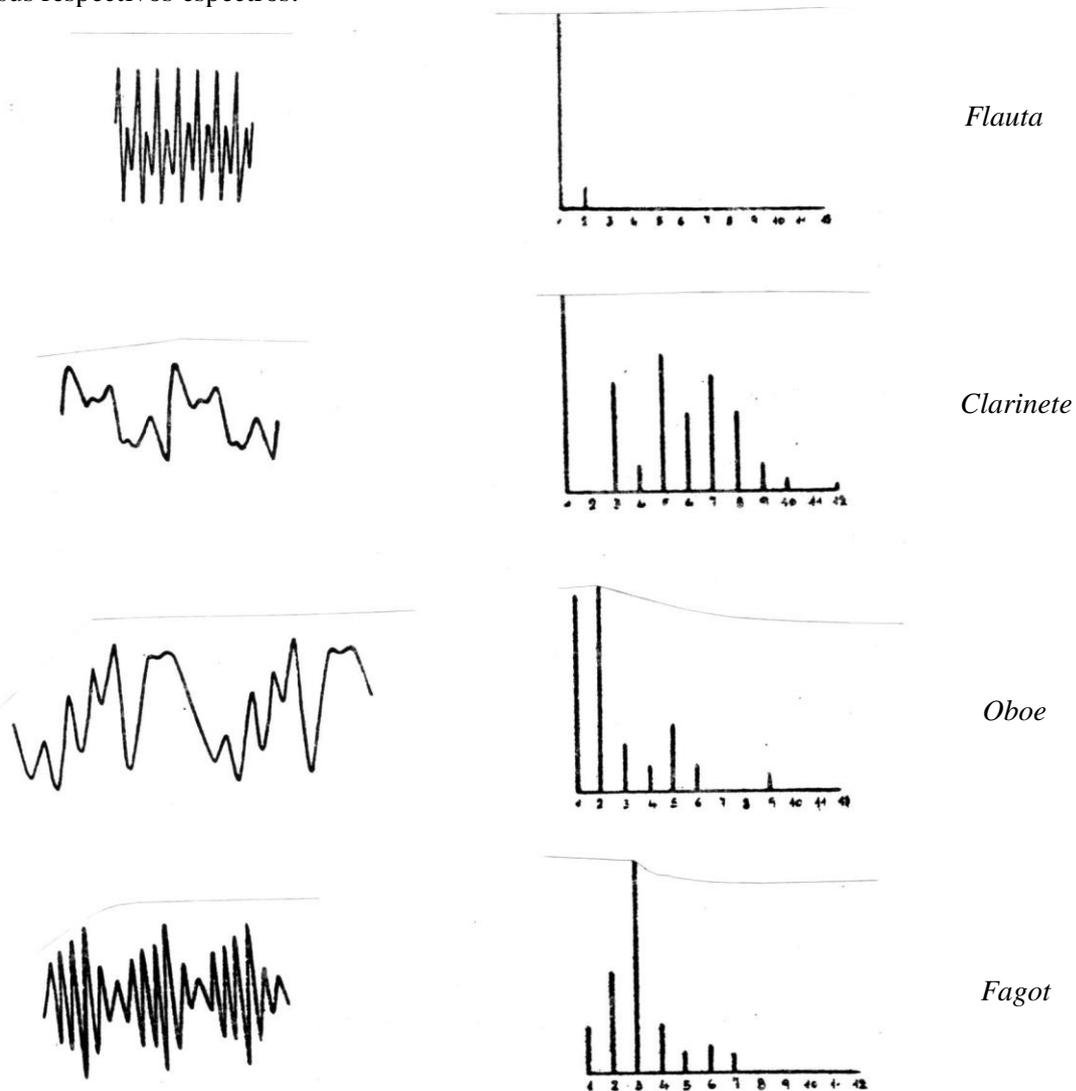
Hemos visto que la cantidad de componentes que conforman un sonido, sus frecuencias e intensidades, determinan el espectro del sonido. Distinguimos un violín de un piano, en parte, porque sus espectros son diferentes. En las figuras que siguen vemos a la izquierda un sonido
