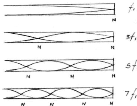
La presión sobre el extremo cerrado varía entre un máximo y un mínimo, en el extremo abierto permanece constante (presión ambiente)
