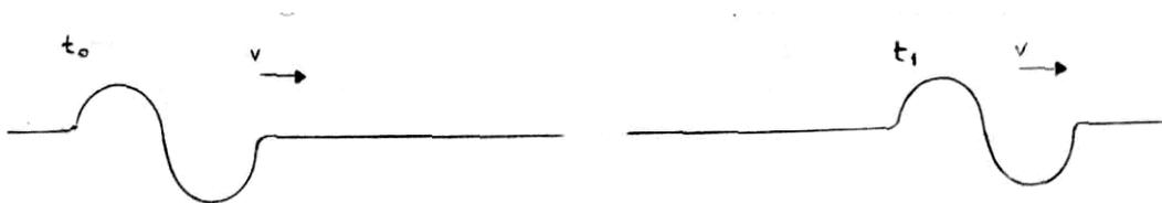
Al cabo de un tiempo habrá avanzado un cierto espacio (igual a  $vt$ ). Podemos fotografiar instantáneamente al impulso para poder representarlo gráficamente y observar su amplitud y su longitud de onda:
