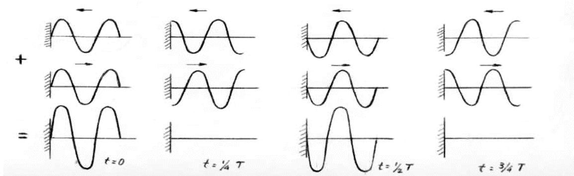
Como la energía de la onda no puede fluir más allá de los puntos de reposo de la cuerda, decimos que se trata de una onda estacionaria.
