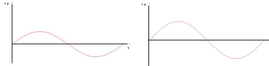
Dos movimientos de igual fase y amplitud, pero de distinta frecuencia:
