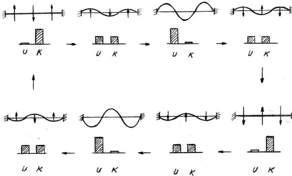
Las flechas representan la magnitud de la velocidad de ciertas partículas de la cuerda. Cuando estas porciones se hallan en su amplitud máxima, la velocidad es cero y la energía potencial es máxima. (recordar el sistema masa-resorte).
