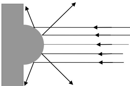
**Reflexión difusa:** se produce cuando el tamaño de las irregularidades de una superficie reflectora son comparables al de la longitud de la onda incidente.
