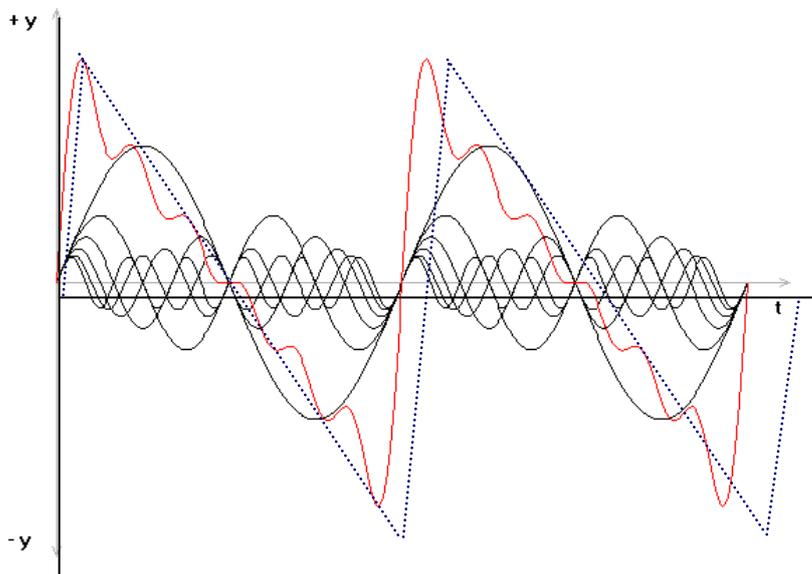
Si agregáramos un número mayor de armónicos la curva tendería hacia la línea de puntos. La frecuencia de los armónicos está dada por la relación  $f_n = n \cdot f_1$ , donde  $n$  es el número de armónico;  $f_n$  es la frecuencia del armónico  $n$  y  $f_1$  es la frecuencia del primer armónico, llamado también fundamental.
