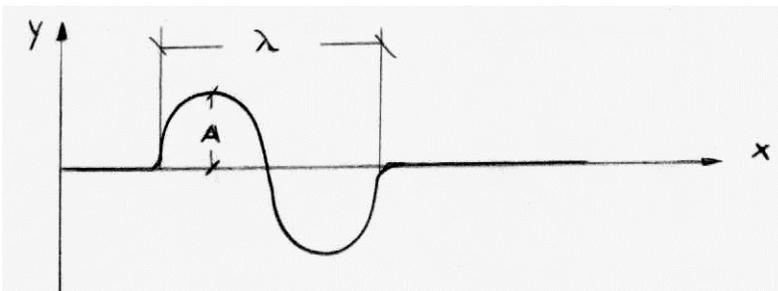
Ambas coordenadas corresponden a las dimensiones de la onda ( $y$  = amplitud;  $x$  = longitud de onda). No hay que confundir este gráfico con el movimiento, donde el eje  $x$  corresponde al tiempo.
