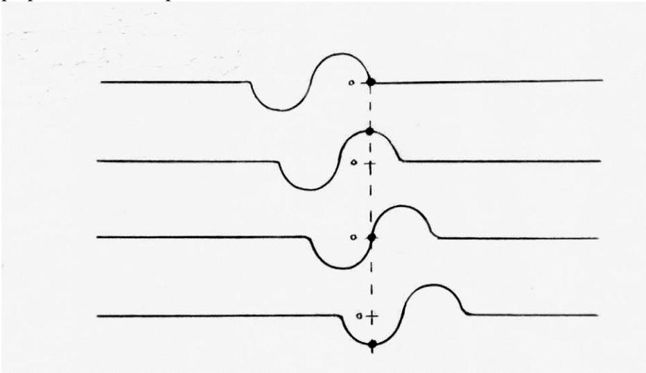
Representemos el movimiento de un punto de la cuerda en función del tiempo. Es el mismo gráfico que corresponde al movimiento producido por la fuente en función del tiempo. Con una cuerda suficientemente larga la onda viajará infinitamente (siempre que no consideremos los rozamientos) y sin modificar su amplitud.
