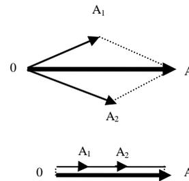
Si ambos desplazamientos tienen la misma dirección su suma es algebraica. Podemos resolver la composición de movimientos a través de la representación gráfica, sumando las elongaciones de los movimientos componentes y hallando la resultante.
