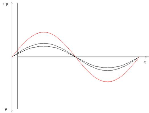
c) Dos movimientos de igual frecuencia y amplitud, pero de distinta fase.
