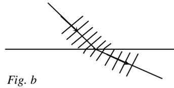
La refracción se debe a la diferencia de velocidad de propagación que los dos medios poseen. Un frente de onda, al ingresar oblicuamente en otro medio, sufre un desplazamiento. El frente va cambiando parcialmente su velocidad a medida que toma contacto con el segundo medio. (Fig b)
