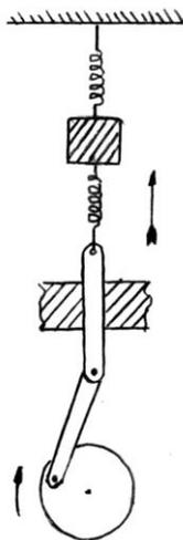
Como se ve en la figura, podemos entregar energía al sistema en la medida en que hacemos girar la rueda ubicada en la parte inferior. A bajas revoluciones, la masa del sistema oscila acompasadamente con el movimiento giratorio que lo produce, de manera forzada. A medida que la velocidad de giro aumenta, aumenta también la frecuencia de la masa y el resorte.
