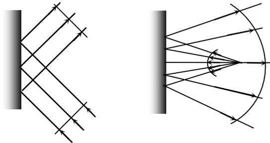
Si la superficie de separación de los medios no es plana, sino parabólica, los rayos se concentran en el **foco** de la parábola:
