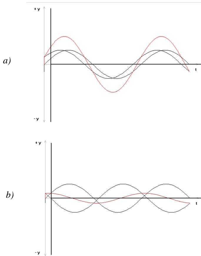
Si la diferencia de fase es próxima a  $0^\circ$ , la amplitud resultante será casi el doble de la amplitud de los componentes (*Fig. a*). En cambio, si es próxima a  $180^\circ$ , la amplitud se aproximará a cero. (*fig. b*)
