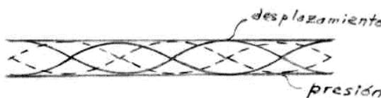
Una columna gaseosa, al igual que una cuerda, puede vibrar de varios modos, los cuales corresponden a la serie armónica. Los gráficos siguientes muestran la ubicación de nodos y vientres de desplazamiento para cada armónico de un tubo abierto.
