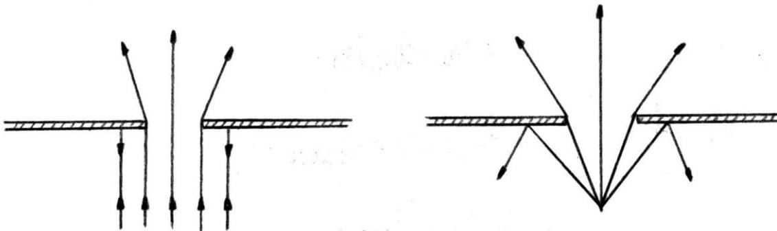
En ambos casos (frente plano y circular) la onda se dispersa en la abertura como si se hubiera generado allí, por lo cual se produce difracción.
