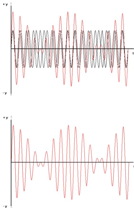
La frecuencia con que varía la amplitud de la resultante es igual a la diferencia de las frecuencias de las componentes.
