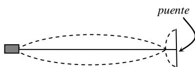
El puente, en los instrumentos de cuerda, no actúa como un punto rígido, sino más bien como una membrana, que permite la transmisión de las vibraciones a la caja de resonancia.
