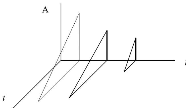
Se ve en la figura superior que las tres componentes de este sonido decrecen en intensidad a medida que el tiempo transcurre, pero lo hacen cada una de manera distinta: la primera componente desciende en amplitud más lentamente que las demás. La tercera componente es la que más rápidamente se extingue. A medida que el tiempo pasa, el sonido se hace cada vez más pobre. Se desprende de aquí que el espectro es meramente instantáneo: se refiere a un instante particular del sonido.
