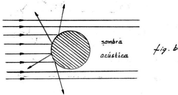
La longitud de onda es menor que el tamaño del objeto: no existe difracción y se produce sombra acústica (*Fig. b*)
