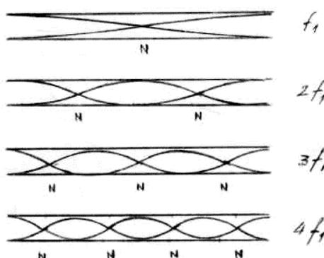
El tubo, al ser abierto, permite la existencia de vientres de desplazamiento en ambos extremos, ya que las moléculas, en estas regiones, pueden vibrar libremente.
