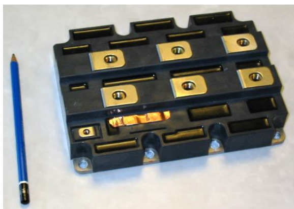
IGBT de 1200A y 3.3kV (h/6kV)
