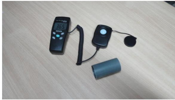
Figura 4 a. Luxómetro Tenmars TM - 201 con su sonda con sensor de fotodiodo y filtro. Se observa el implemento cilíndrico construido para medir brillo con el negatoscopio en condiciones normales de funcionamiento.
