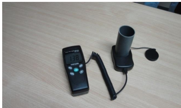
Figura 4 b. Luxómetro Tenmars TM - 201 con el implemento calzado en la sonda. El conjunto se apoya en la superficie difusora del negatoscopio encendido en condiciones normales de funcionamiento.
