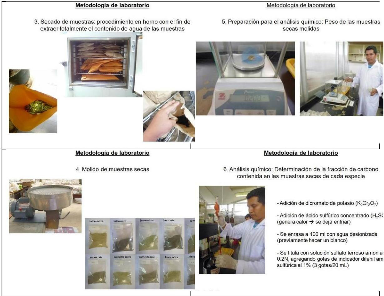
Figura 3. Detalles de cada etapa del proceso de laboratorio. Superior-izquierda: secado de muestras. Inferior-izquierda: molido y rotulación de muestras secas. Superior-derecha: registro del peso de muestras secas. Inferior-derecha: análisis químico para la determinación de la fracción de carbono en muestras a partir del análisis de laboratorio.
