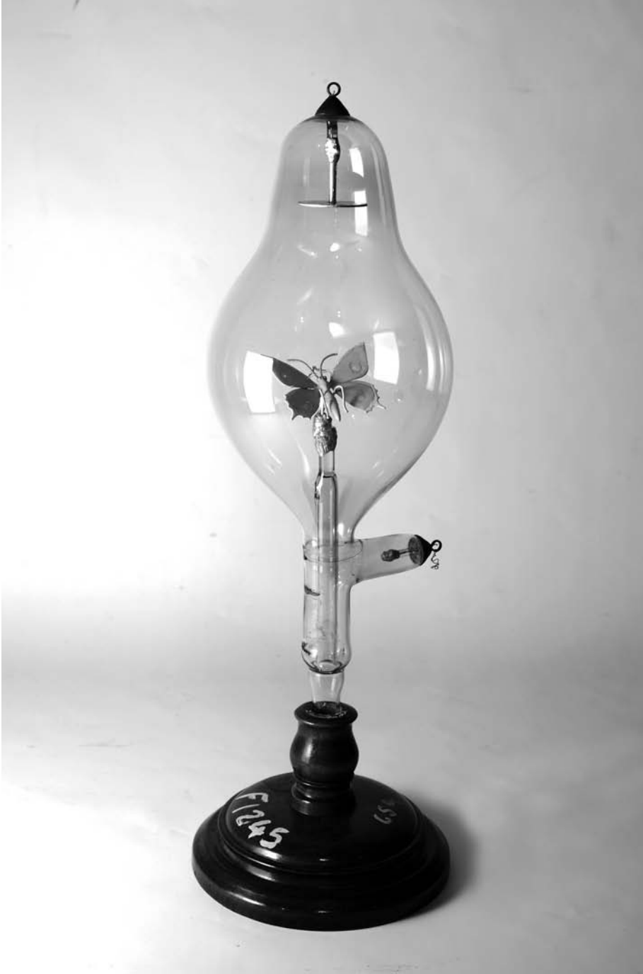
Aparato de Puluje para experiencias con materia radiante. Ampolla de vidrio con mariposa. Max Kohl 1906. Colección Museo de Física UNLP.
