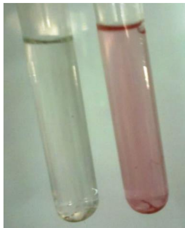
Figura 2. Control negativo (izquierda) y control positivo (derecha) típicos obtenidos en ensayos de determinación de viabilidad celular empleando TTC. Nótese a la derecha la coloración rojiza característica del formazán generada por reducción enzimática del TTC cuando las bacterias crecen en un medio conteniendo Glucosa como fuente de carbono.
