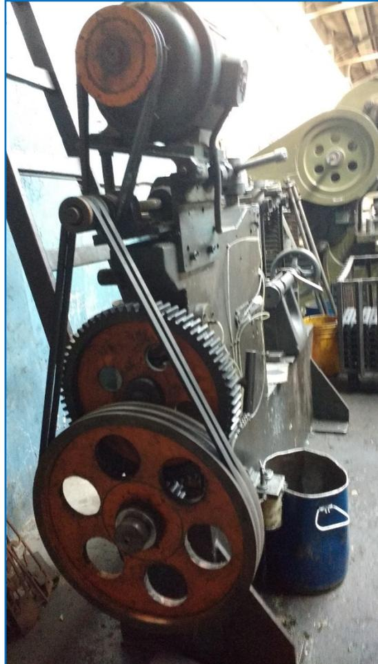
Imagen 17: Mecanismo de transmisión de movimiento del motor de la cortadora de chapa. (Imagen suministrada por la empresa)
