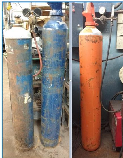
Imagen 23: Tubos de gas para soldadura oxiacetilénica (izquierda) y M.I.G. (derecha).
