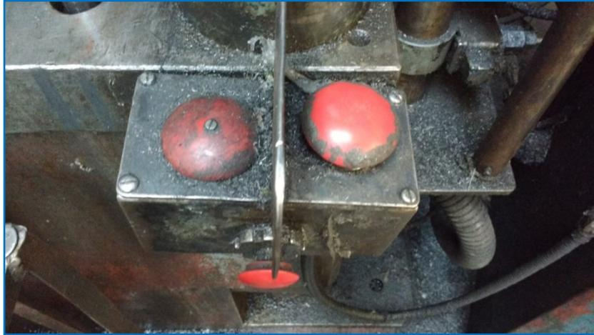
Imagen 14: Botonera de la Prensa Hidráulica de 150 Tn. El botón de la derecha acciona la prensa para que baje. El botón inferior es el de la parada de emergencia. El botón izquierdo por el momento se encuentra inutilizado. (Imagen suministrada por la empresa)
