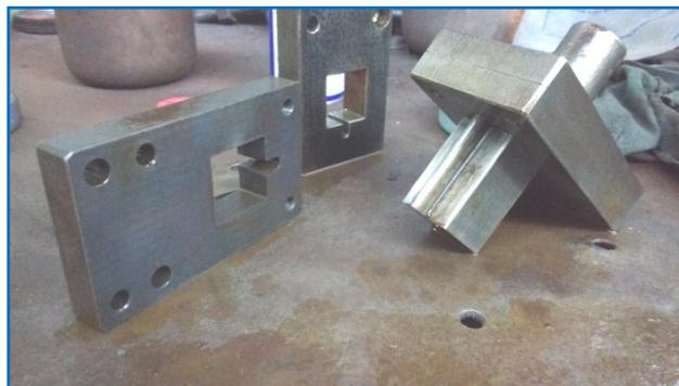
Imagen 2: Ejemplo de una matriz de corte desarmada (no relacionada con el proceso)
