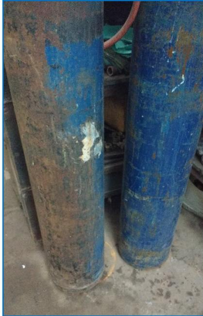
Imagen 22: Tanques de oxígeno para soldadura oxiacetilénica sin etiquetar.
