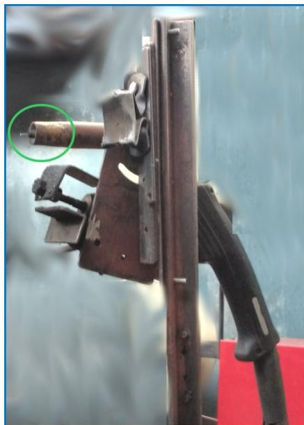
Imagen 7: Detalle de la pistola de soldadura M.I.G. sobre base de apoyo. En verde se señala el pico de salida del alambre de aporte cuando se acciona el gatillo (Imagen suministrada por la empresa)
