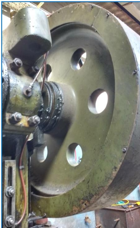
Imagen 10: Cara interior del volante de inercia del balancín de 60 Tn (Imagen suministrada por la empresa)
