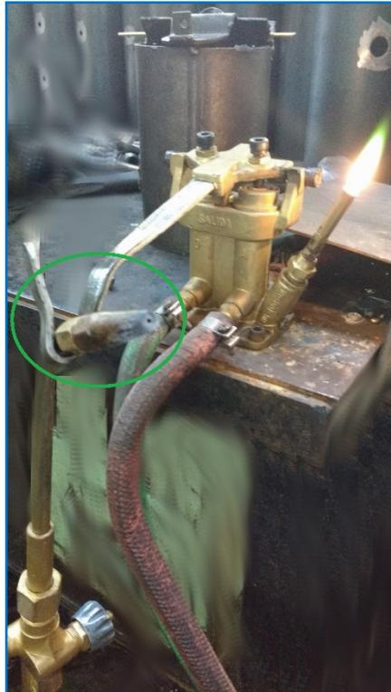
Imagen 8: Detalle de torcha para soldadura oxiacetilénica. En verde, la boca de salida del oxígeno y el acetileno
