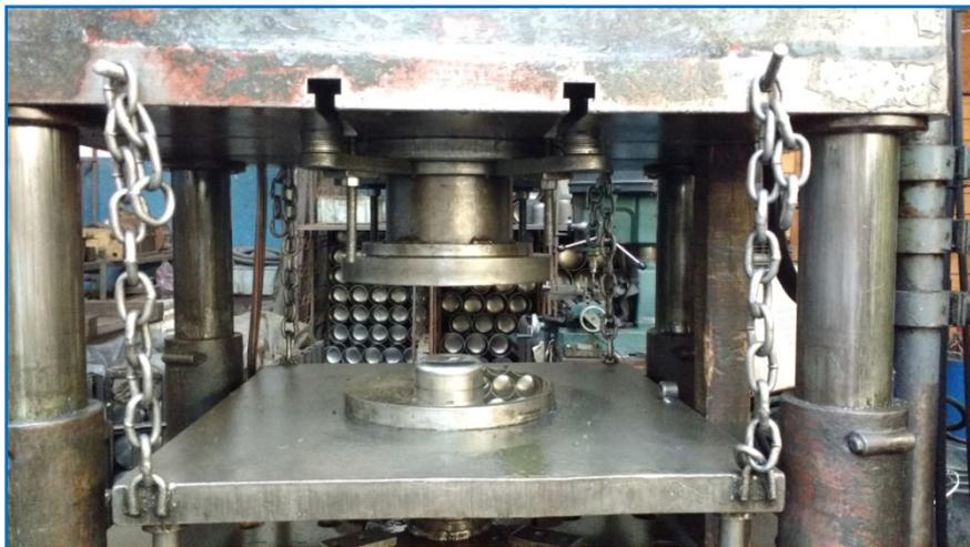
Imagen 13: Detalle de la zona de trabajo en la Prensa Hidráulica de 150 Tn donde no se observa rejas ni protecciones. (Imagen suministrada por la empresa)
