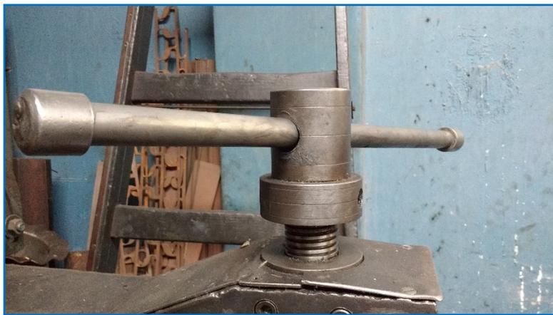
Imagen 15: Detalle de la palanca que ajusta manualmente los dos cilindros giratorios de la máquina cortadora de chapa. (Imagen suministrada por la empresa)
