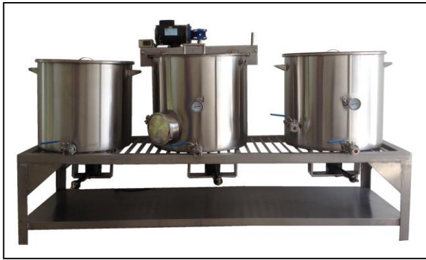
Imagen 4.4-5: Tanques de agua, macerado y hervido (Fuente: inoximexico.com )
