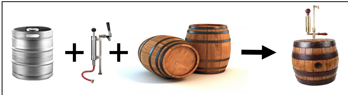
Imagen 7.5-2: Prototipo, el barril de madera cumple una función estética como a su vez la de contener el hielo alrededor del tanque de acero
