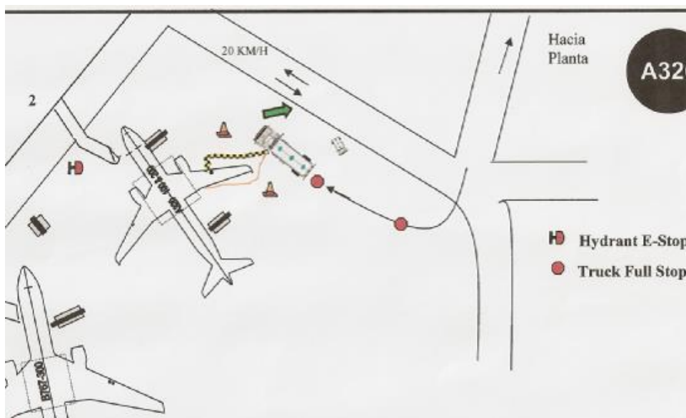
Imagen: Stand Plan indicando como posicionar el camión respecto al avión
