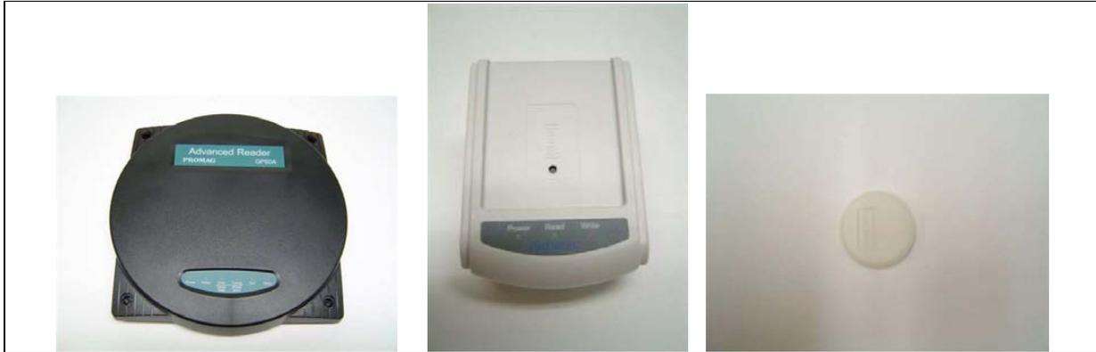
Para poner en funcionamiento al lector RFID se construyeron una interfaz de datos RS-232 y una fuente regulada con filtros de ruido, ya que el lector de RFID era sensible a las interferencias electromagnéticas. Todos estos elementos fueron construidos durante Mayo de 2004.
