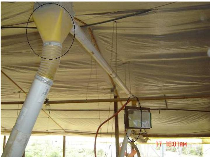
Foto C22) Caño del Silo visto desde abajo del galpón, hasta llegar a la última bajada, en la misma foto se ve el motor del segundo sinfín.
