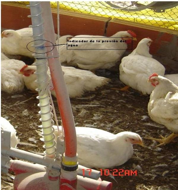
Foto n°6N. Manguera indicadora del nivel de presión.
