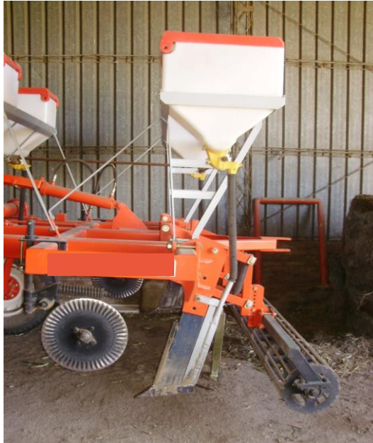
Figura 8. Subsolador con dosificador para aplicación de enmienda en profundidad, utilizado para el ensayo de métodos de aplicación.
