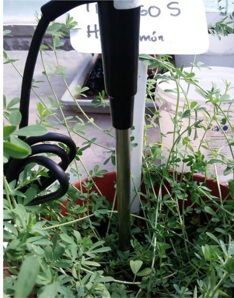
Figura 7 - Medición de actividad eléctrica de la tierra de las macetas (Modelo HI 993310, Hanna Instruments).
