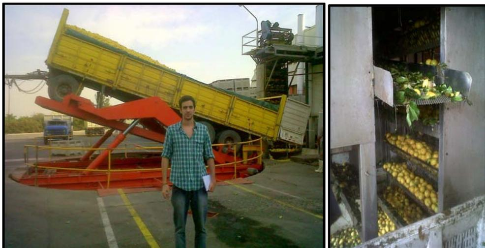
Figura N° 14 y N° 15: Descarga del camión a piletones, y elevadores que conducen a rolo clasificador. Fuente: Landa, R. Ignacio (2013).
