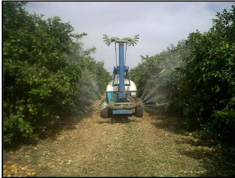
Figura N°10: Máquina pulverizadora del establecimiento Huasa Rincón, Tucumán.
