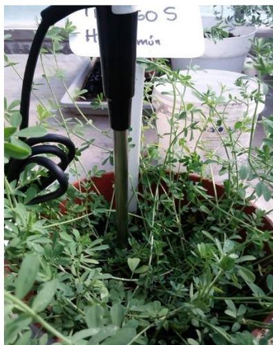
**Ilustración 4:** Medición de Conductividad eléctrica con el conductímetro *Hanna HI 993310*
