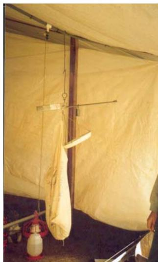
Foto N° 5: Balanza utilizada para las mediciones de peso de los pollos parrilleros.
