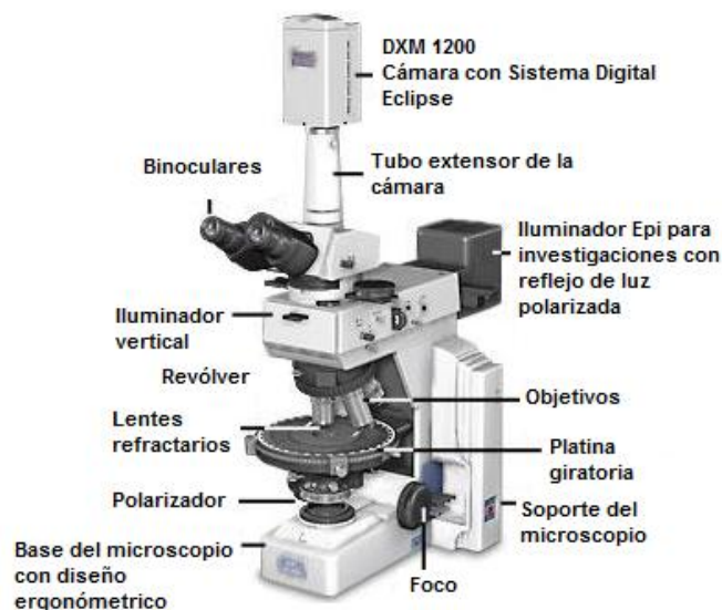
Figura N°13: Esquema del modelo Nikon E200. Fuente: www.microscopyu.com
