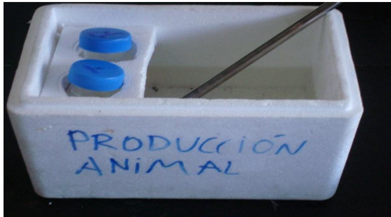
Imagen N° 13: Termómetro marcando la temperatura de almacenamiento de los tubos R y T (5°C).
