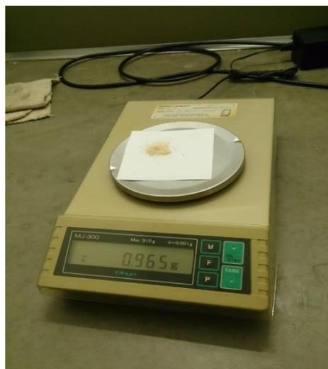
*Figura N° 16. Pesaje del inoculante.*
