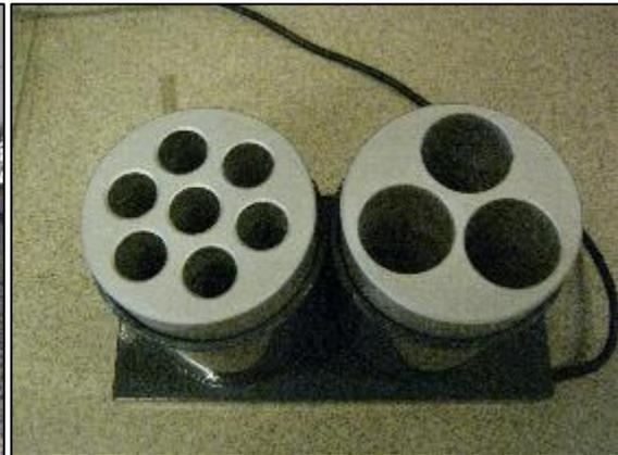
*Imagen 08. Baño termostático Vicking Masson D (izq.) y portatubos Microvisión (der.)*
