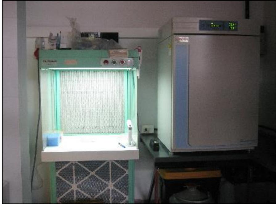
*Imagen 03. Cabina de flujo Filtrar (izq) e incubadora Thermo Scientific (der).*
