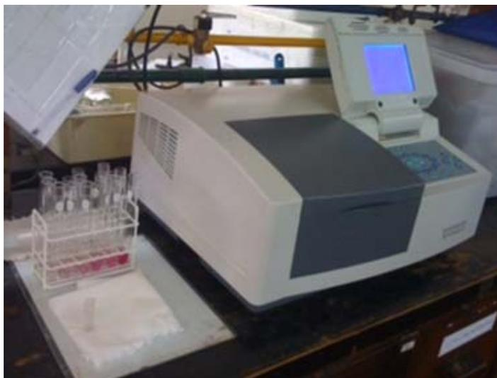
*Imagen 9:* Determinación de ácidos urónicos por espectrofotometría UV.
