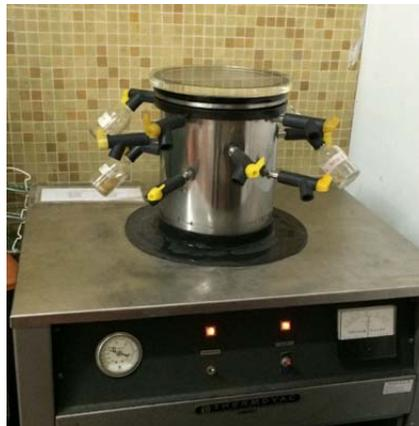
*Imagen 2:* Equipo liofilizador.
