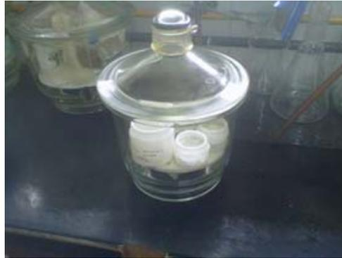
*Imagen 3:* Extractos de CDTA en desecador, listos para ser utilizados en las correspondientes determinaciones.
