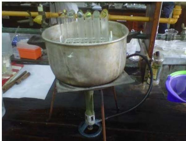
*Imagen 7:* Muestras a baño maría durante el preparado para posterior lectura en espectrofotómetro.
