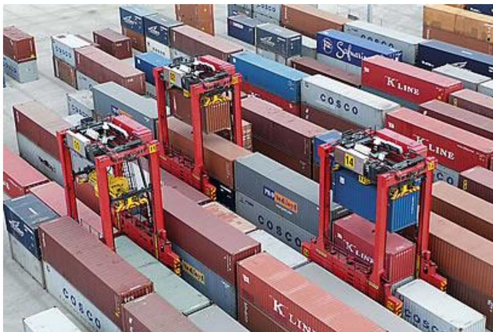
FIGURA 8 – Straddle Carriers estibando contenedores de forma lineal (linear stacking).
