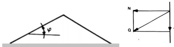
Figura 3.46 – Ángulo de talud natural y componentes de empuje.
