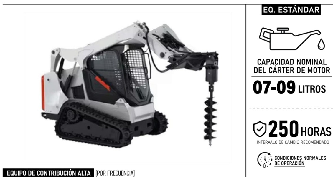
Gráfico 10 - Ficha técnica de capacidad del cárter e intervalo de cambio recomendado en Mini cargadora con implemento. Fuente: Elaboración propia en Adobe Illustrator basándose en manuales técnicos del fabricante. Foto original: [ https://spanish.alibaba.com/g/hydraulic-auger-crane-pile-driver.html ].
