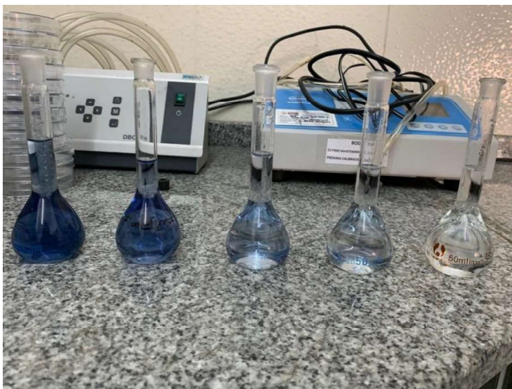
Figura 28: preparación de la curva de calibración preparada con una solución patrón conocida.
