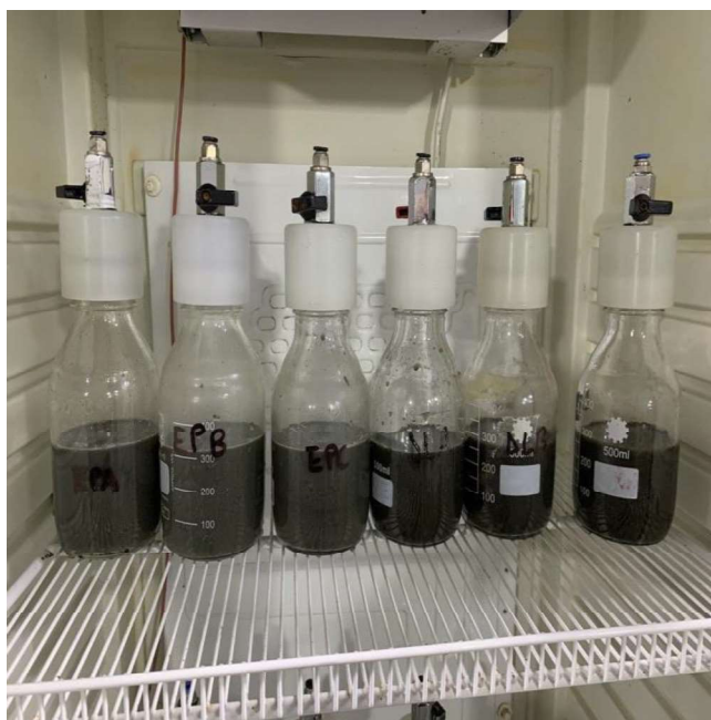
Figura 30: reactores Schott-Duran colocados en la incubadora.
