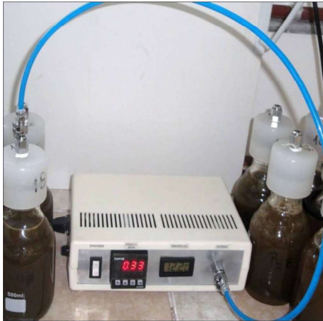
Figura 31: Medición del volumen de gas, mediante equipo manométrico.
