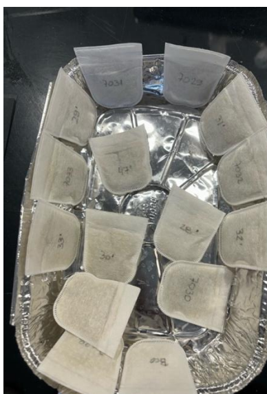
Fig. 9 - Bolsas filtrantes Ankom F57 identificadas con 0,5 g de muestra y selladas.
