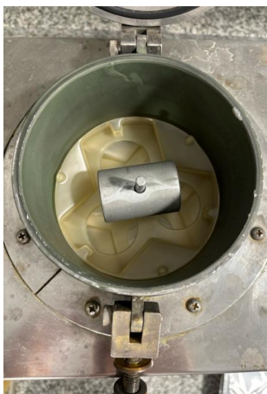
Fig. 11 – Detalle del equipo Ankom con las bolsitas previo al agregado de la solución detergente neutro.
