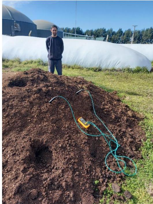
**Figura 10.** Monitoreo de la temperatura sobre las pilas de tratamiento. Fuente: propia
