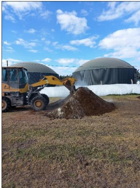
**Figura 9.** *Aireación de las pilas de DPTF con la retroexcavadora.* *Fuente: propia*
