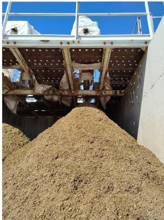
**Figura 4.** Salida del DSP del sinfín con un filtro estándar de acero inoxidable.
