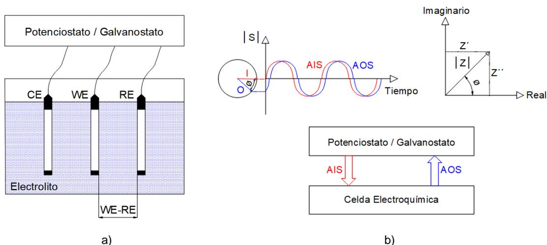
**Figura 1.** Esquemización del funcionamiento de la espectroscopia de impedancia electroquímica.
