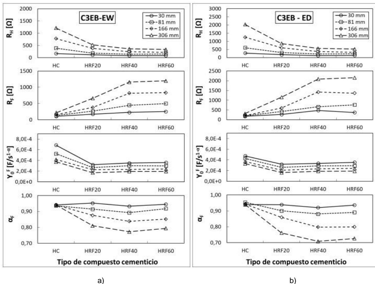
**Figura 10.** Valores de componentes del circuito equivalente asociados a la formación del SCFI, en función del dosaje de fibras y obtenidos a partir de mediciones ejecutadas bajo la configuración de tres electrodos tipo barra (C3EB). a) Medición en estado húmedo. b) Medición en estado seco.
