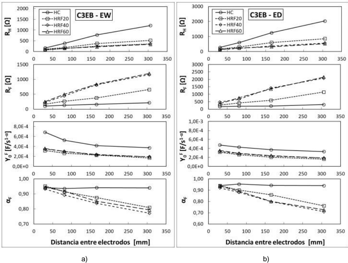
**Figura 9.** Valores de componentes del circuito equivalente asociados a la formación del SCFI, en función de la distancia entre electrodos y obtenidos a partir de mediciones ejecutadas bajo la configuración de tres electrodos tipo barra (C3EB). a) Medición en estado húmedo. b) Medición en estado seco.
