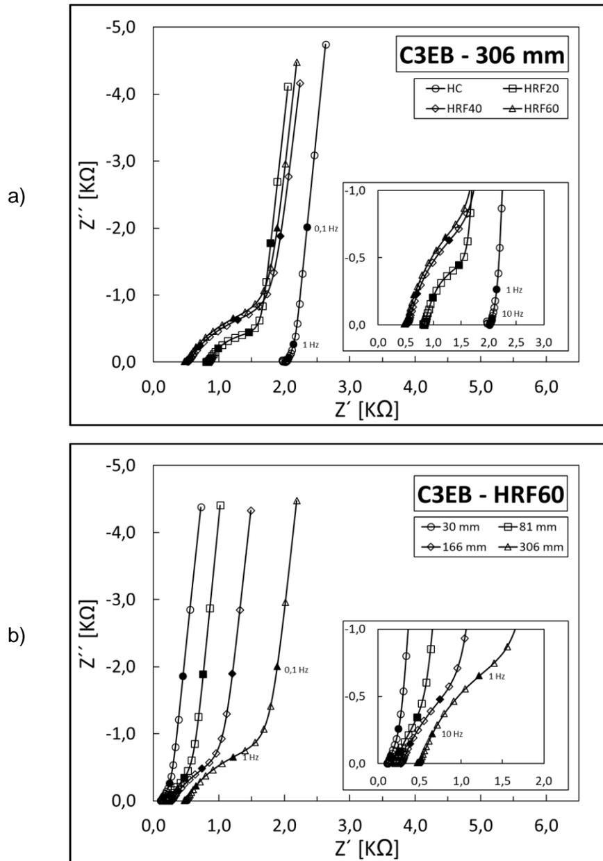
**Figura 7.** Contraste de diagramas de Nyquist registrados con una configuración de tres electrodos tipo barra (C3EB). a) Impacto de la dosis de fibras para una distancia de 306 mm entre electrodos. b) Impacto de la distancia entre electrodos para un hormigón reforzado con 60 kg/m<sup>3</sup> de fibras (HRF60).
