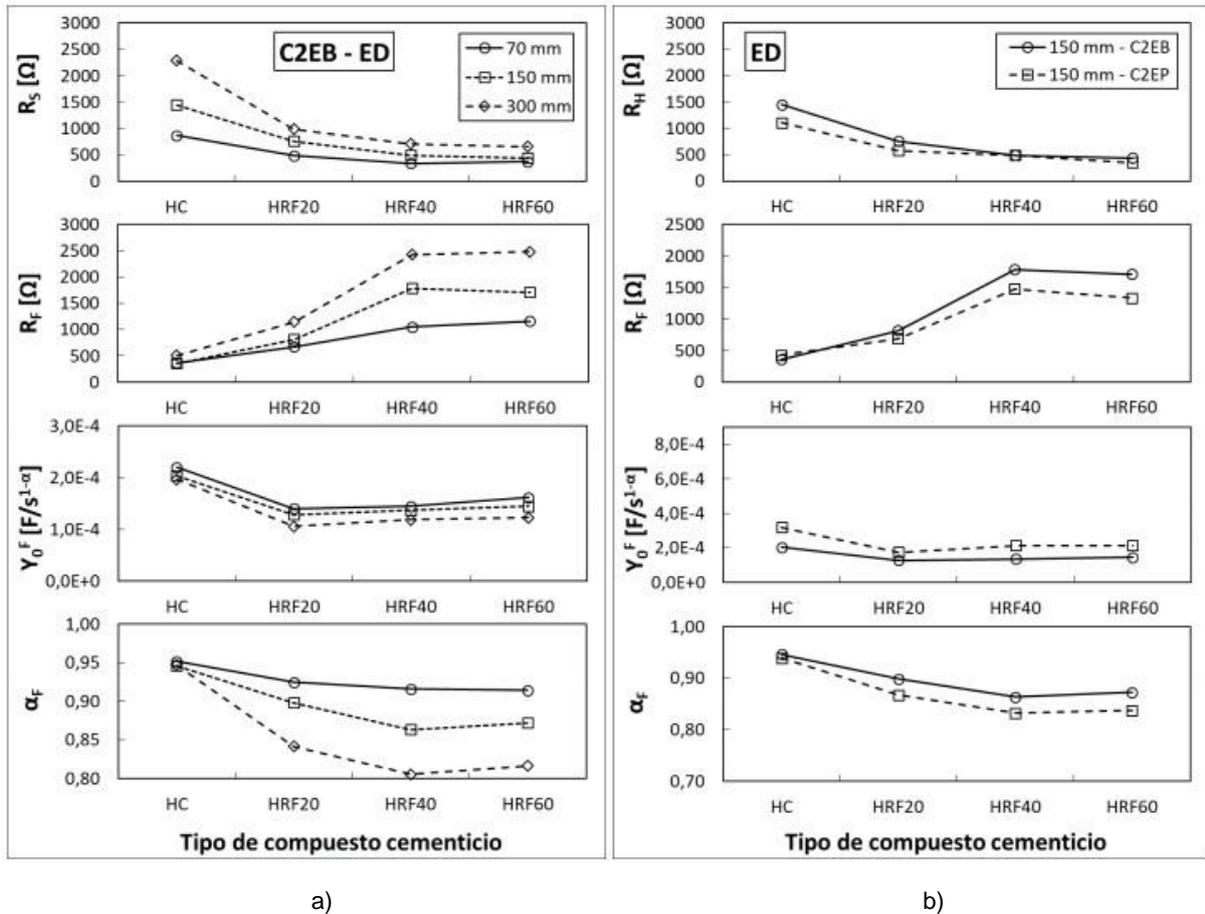
**Figura 11.** Valores de componentes del circuito equivalente asociados a la formación del SCFI, en función del dosaje de fibras y obtenidos a partir de mediciones bajo la configuración de dos electrodos (C2). a) Con electrodos tipo barra a diferente distanciamiento. b) Con dos formatos de electrodos diferentes, ante igual distancia.
