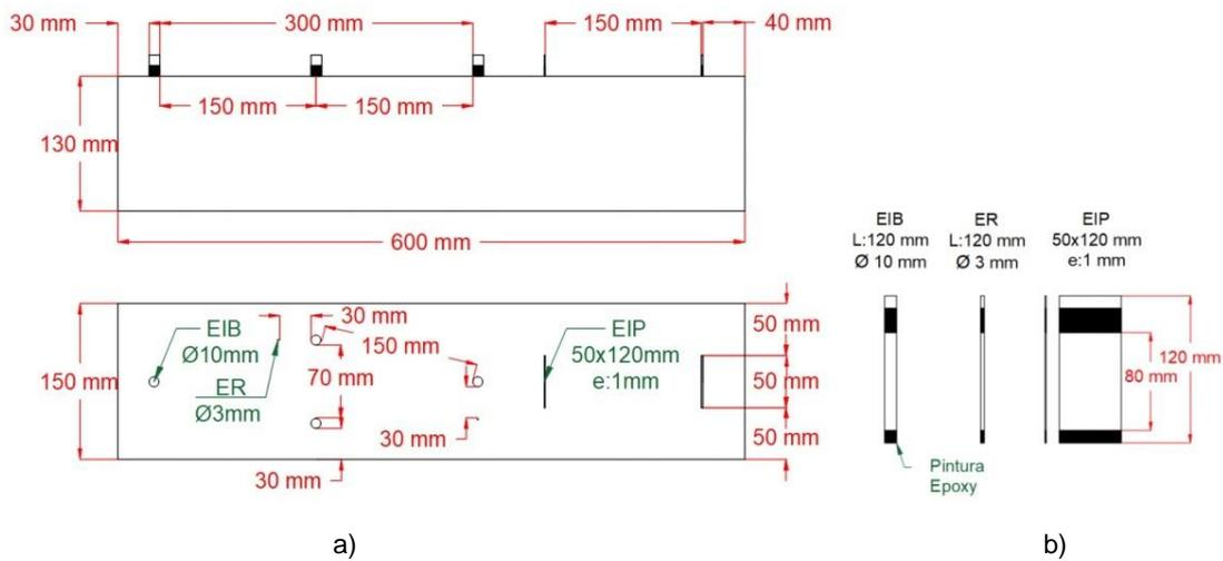
Figura 4. a) Geometría de la probeta. b) Geometría de electrodos embebidos.
