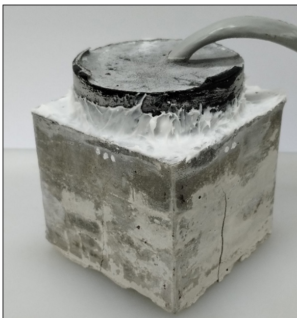
Figura 5 – Patrón de fisuración detectado en probetas de pasta.
