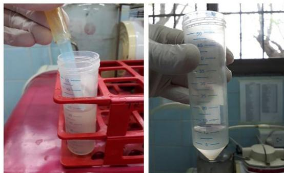
**Fig. 9** Extracción del líquido sobrenadante para obtener un volumen de 10 ml de muestra.
