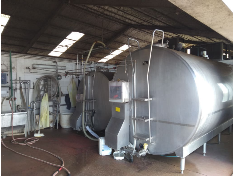
Imagen 4: tanques de almacenamiento de la leche con capacidad de 25.000Lt, fuente propia
