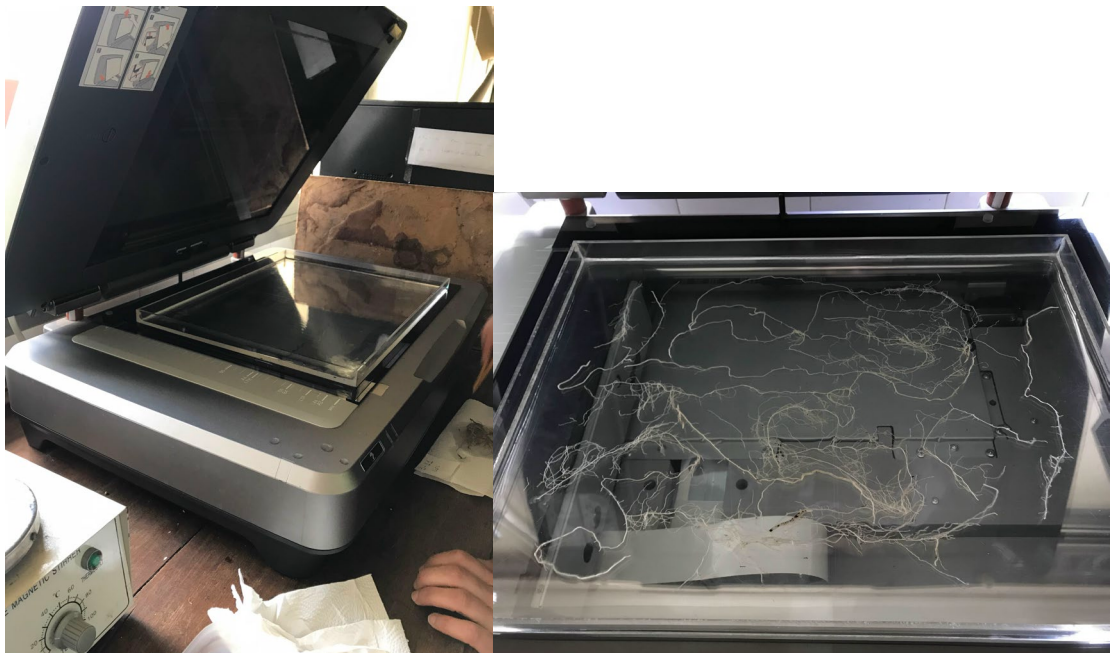
Escáner de alta resolución EPSON Expression 10000XL-Photo® (Seiko Epson Corp., Japón) equipado con una unidad de transparencia
