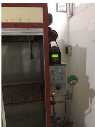
Figura 7: Equipo pulverizador automático con boquilla de cono hueco 8001 marca Teejet del Instituto de Ingeniería Rural INTA-Castelar.
