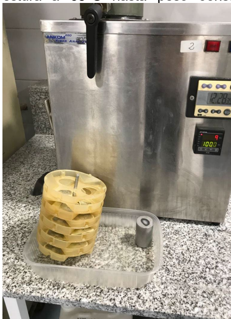
Ilustración 10: Sistema ANKOM utilizado para la obtención de FDN y FDA con su respectiva bandeja, en la cual encontraremos las bolsas rotuladas.
