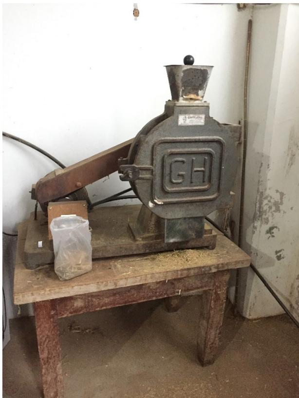
Figura 7. Máquina moledora de forraje previo al análisis de calidad.
