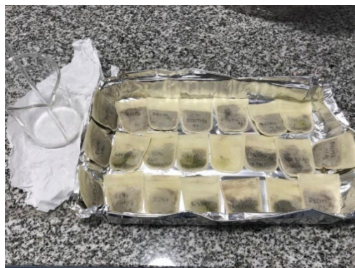
Figura 12: Bolsas filtrantes con material luego del baño con solución detergente neutro.
