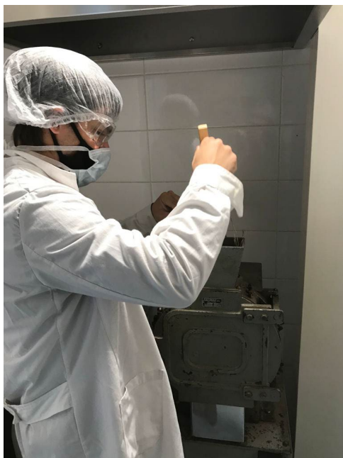
Figura 10: Molienda del material en molino Willey de 2mm.
