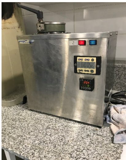
Figura 11: Equipo Ankom, utilizado para hacer los análisis del sistema de detergentes de Van Soest.
