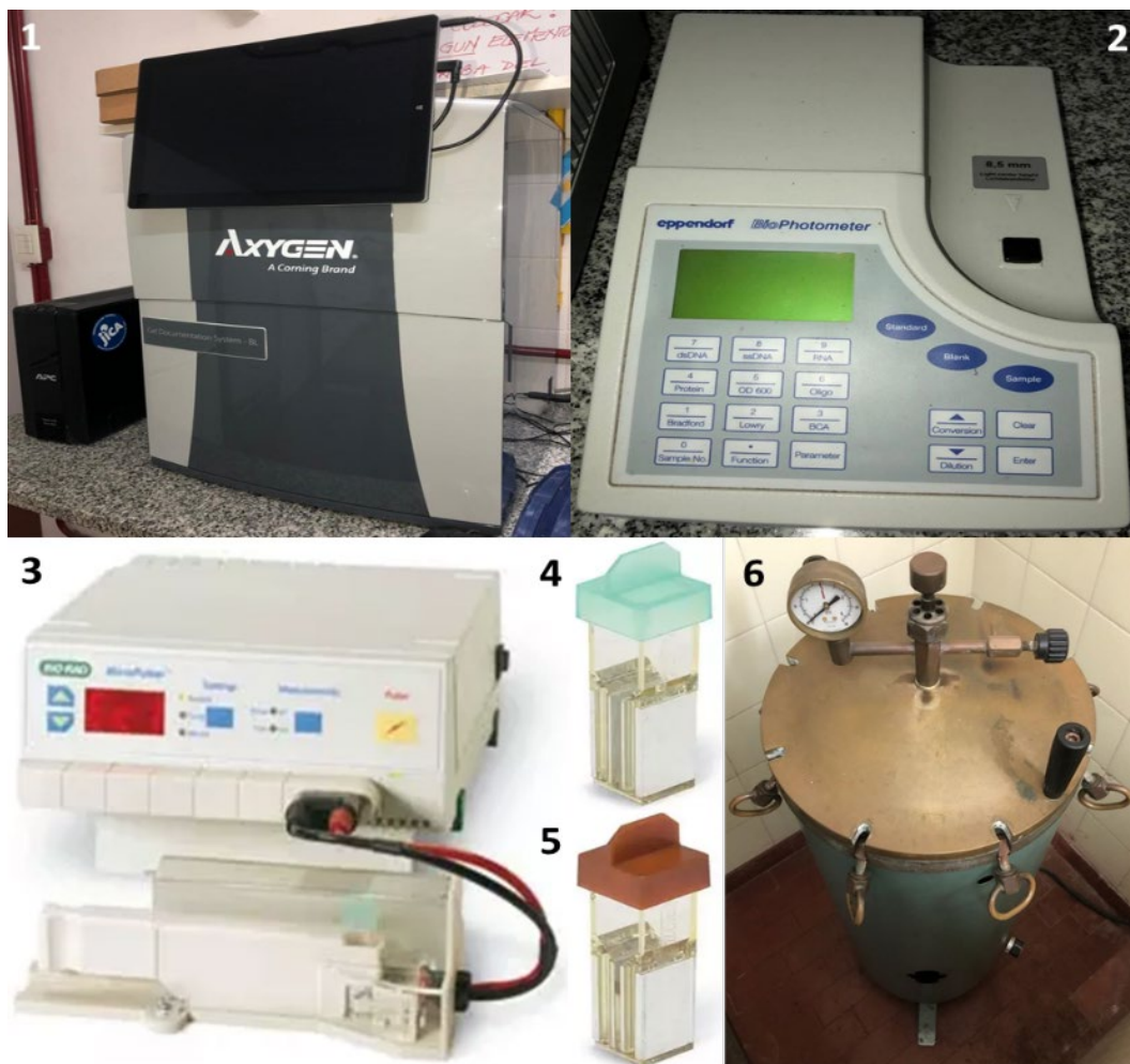
Figura 4. 1-Fotodocumentador; 2-Espectrofotómetro; 3-Electroporador; 4-Cubeta de 0,1 cm; 5-Cubeta de 0,2 cm; 6-Autoclave.
