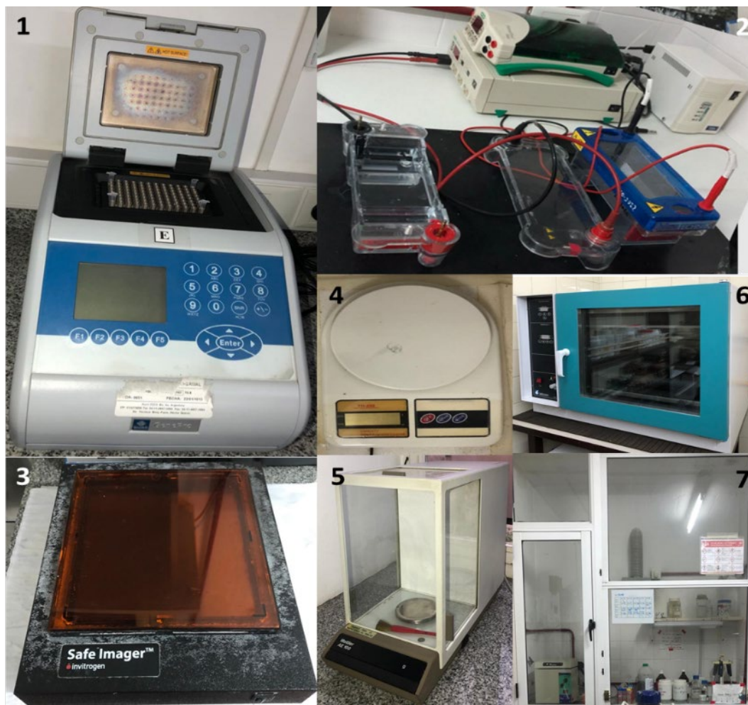
Figura 3. 1-Termociclador; 2-Fuente y cuba electroforética; 3-Transiluminador UV; 4-Balanza; 5-Balanza de precisión; 6-Estufa de cultivo; 7-Campana de extracción.
