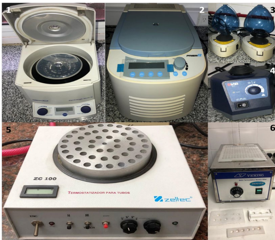
Figura 2. 1-Centrífuga; 2-Centrífuga refrigerada; 3-Centrífuga spinner; 4-Vortex; 5-Placa seca; 6-Baño termostático.
