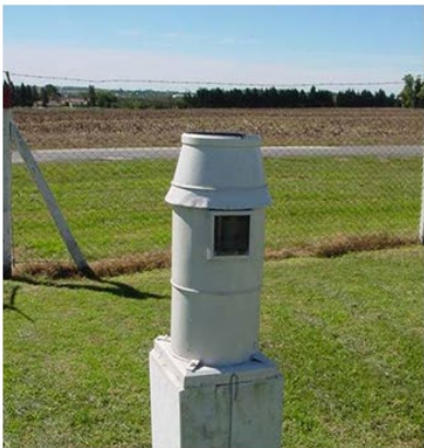
Figura 4. Pluviógrafo tipo flotador
