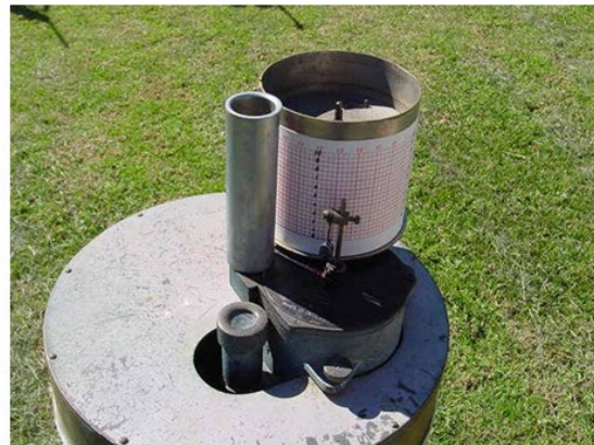
Figura 5. vista de faja en el pluviógrafo tipo flotador.
