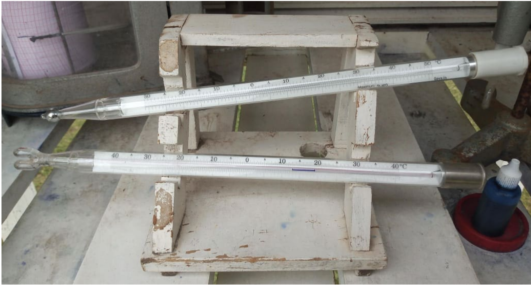
Figura 3. Termómetro de alcohol y termómetro de mercurio para medición de temperaturas máximas y mínimas.
