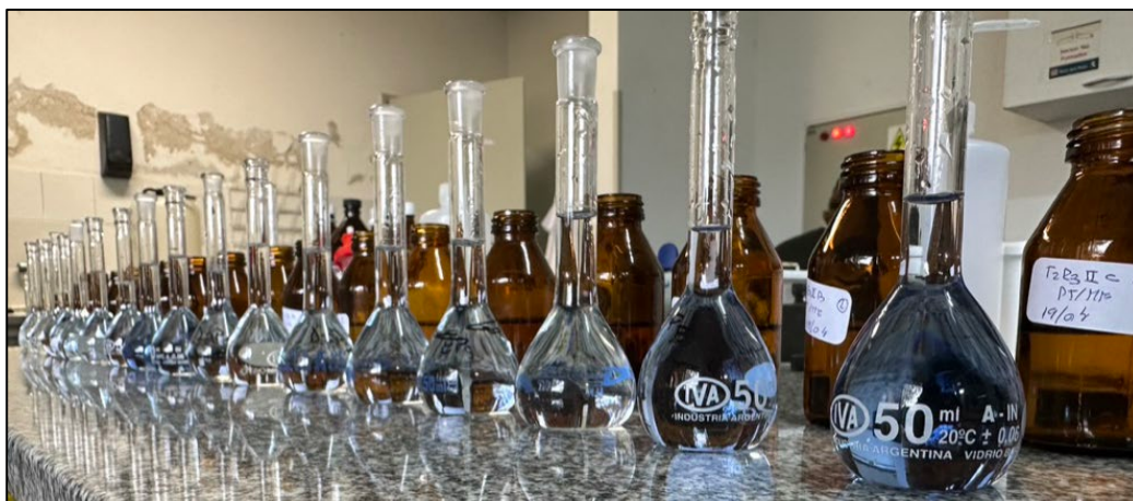
Figura 27. Determinación colorimétrica del ortofosfato contenido en muestras de suelo.
