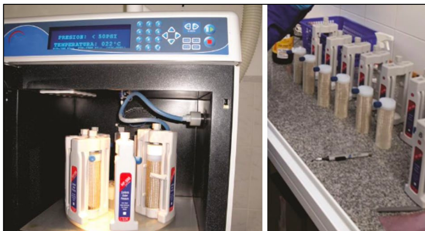
Figura 19. Digestión de las muestras en el equipo de microondas.
