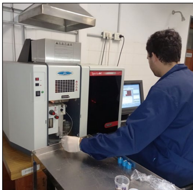
Figura 29. Medición de iones solubles de suelo en equipo de espectrometría de absorción atómica.
