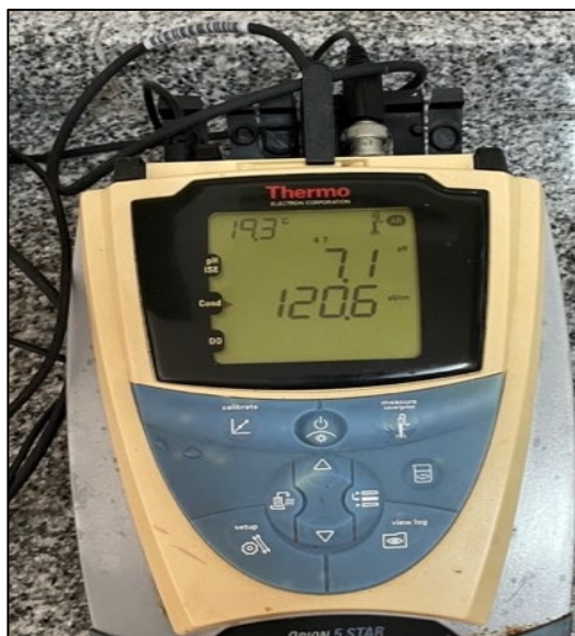
Figura 20. Equipo utilizado para la medición de pH y CE.
