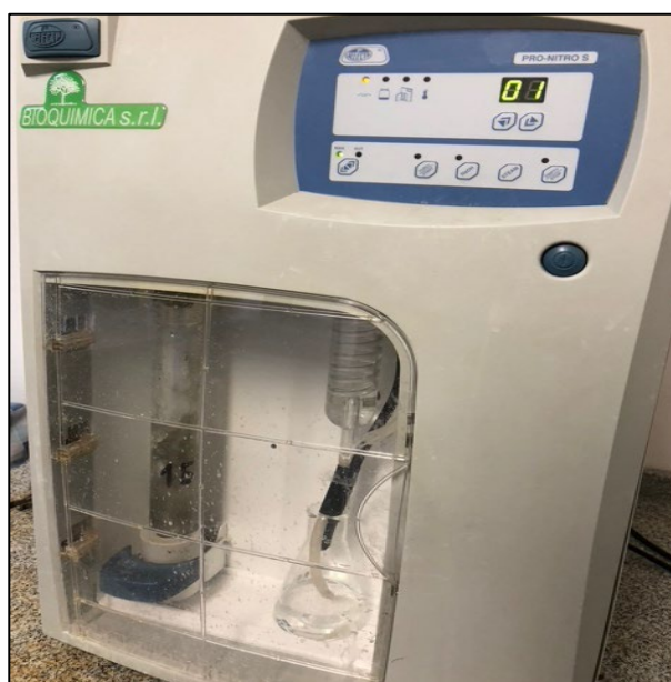
Figura 22. Equipo utilizado para la destilación de las muestras digeridas.
