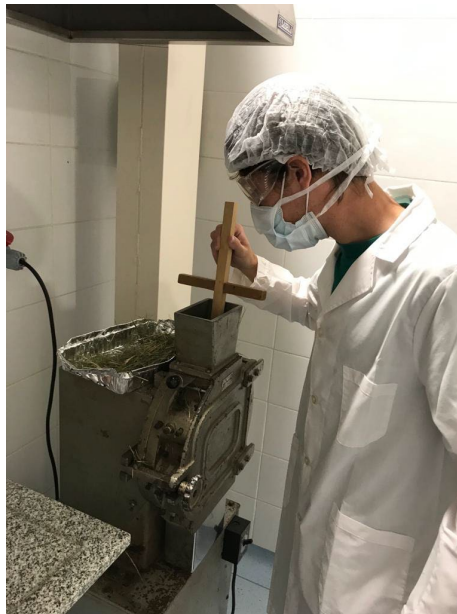
Ilustración 12: Molienda del material, molino tipo Willey.
