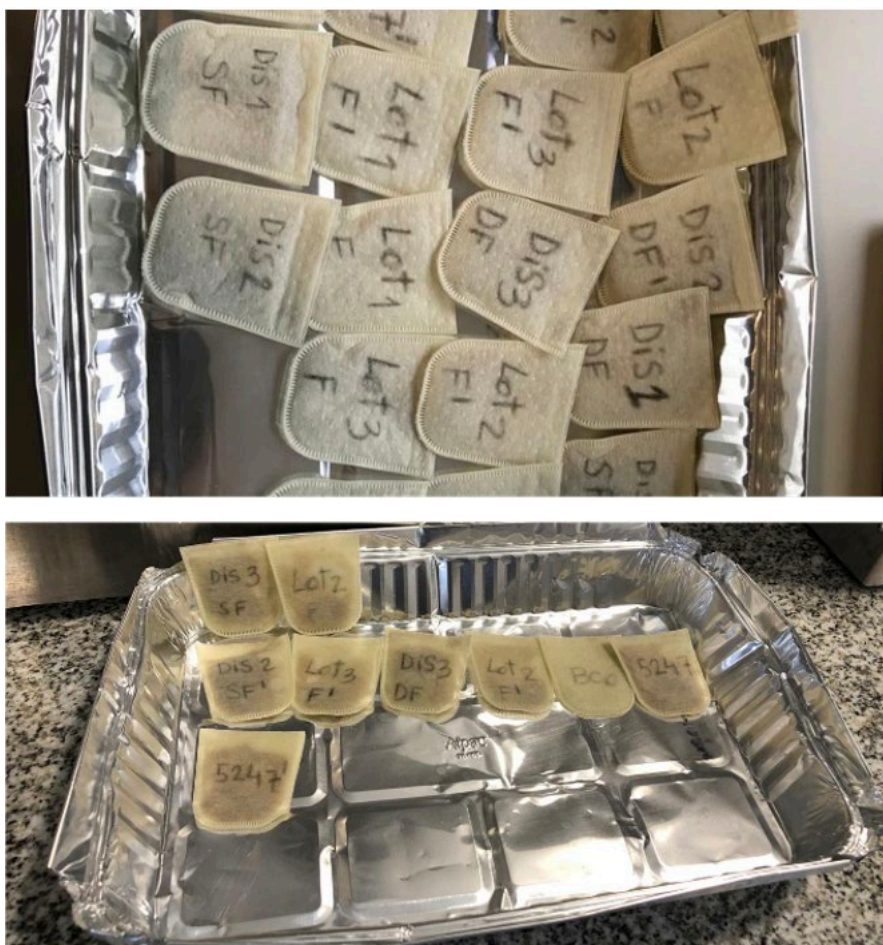
Ilustración 15: A: Detalle de las bolsitas secas luego de la pesada para la obtención del contenido de fibra detergente neutro; B: Detalle de las bolsitas al salir del tratamiento con detergente ácido.
