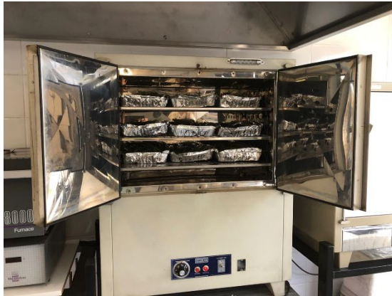
Ilustración 11: A: Estufa de aire forzado utilizada para la determinación de materia seca; B: Detalle de las bandejas con las muestras dentro de la estufa.
