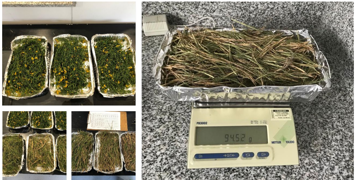
Ilustración 10: A: Muestras limpias de cada especie dispuestas en bandejas; B: determinación inicial del peso de las muestras tal cual (con su humedad) para realizar la determinación del contenido de materia seca.
