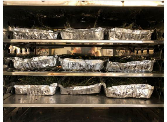
Ilustración 11: A: Estufa de aire forzado utilizada para la determinación de materia seca; B: Detalle de las bandejas con las muestras dentro de la estufa.
