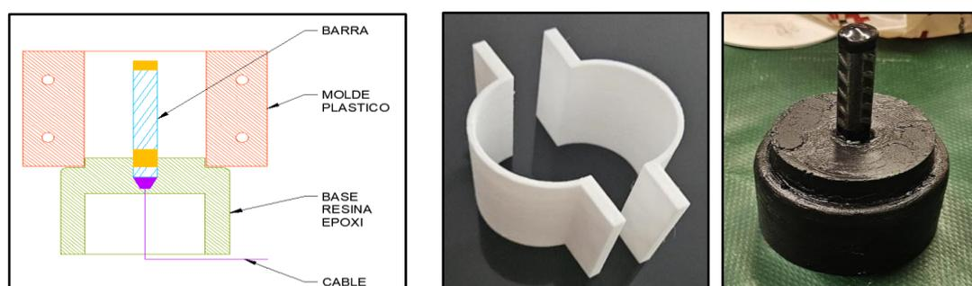
Figura 2.3.a: Características de las probetas para múltiples mezclas.
