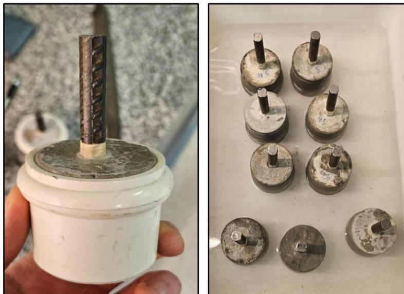
*Figura A1.4: Probetas fraguadas y pasadas a curado.*
