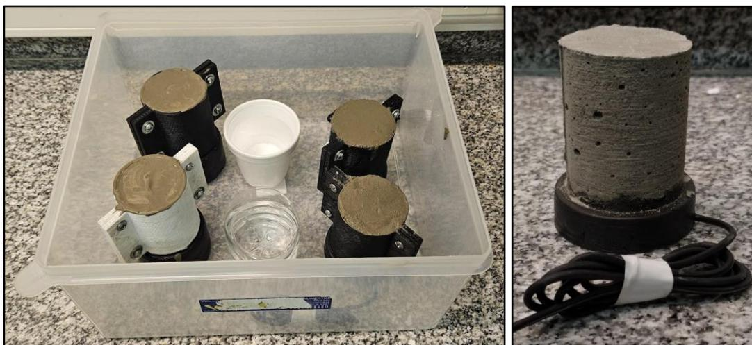
**Figura A2.5: Fraguado y desmolde de probetas.**
