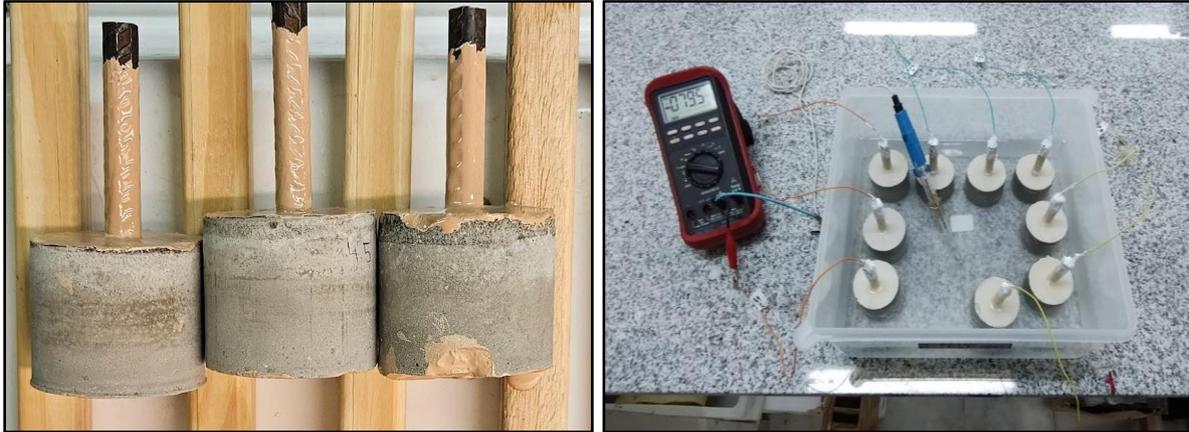
**Figura 2.2.b: Acondicionamiento de probetas y sistema de medición.**
