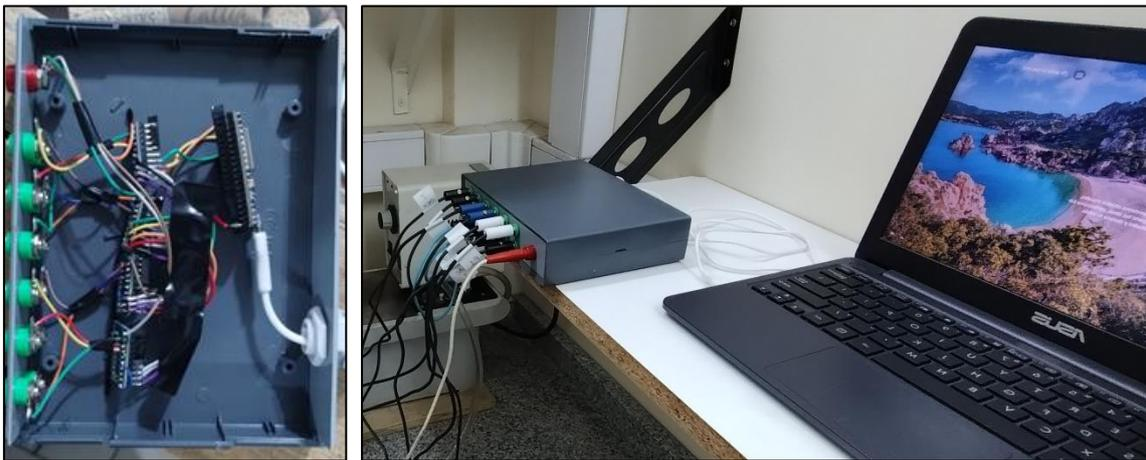
**Figura A3.3: Equipo de registro automático de potenciales de corrosión ensamblado.**
