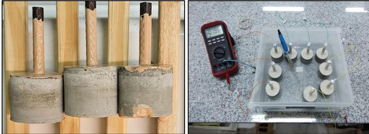
*Figura A1.5: Tratamiento final y conexiones eléctricas de patrones.*
