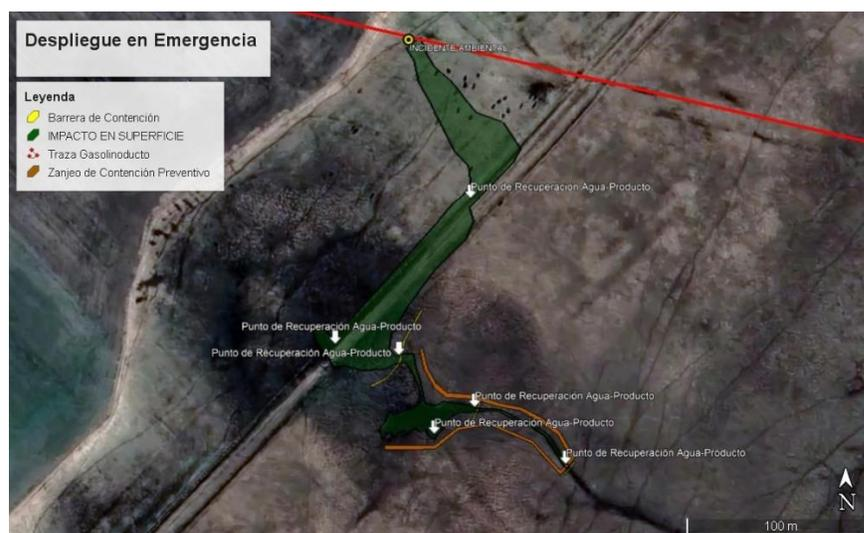
Figura 5: Despliegue de barreras de contención y recuperación de producto
