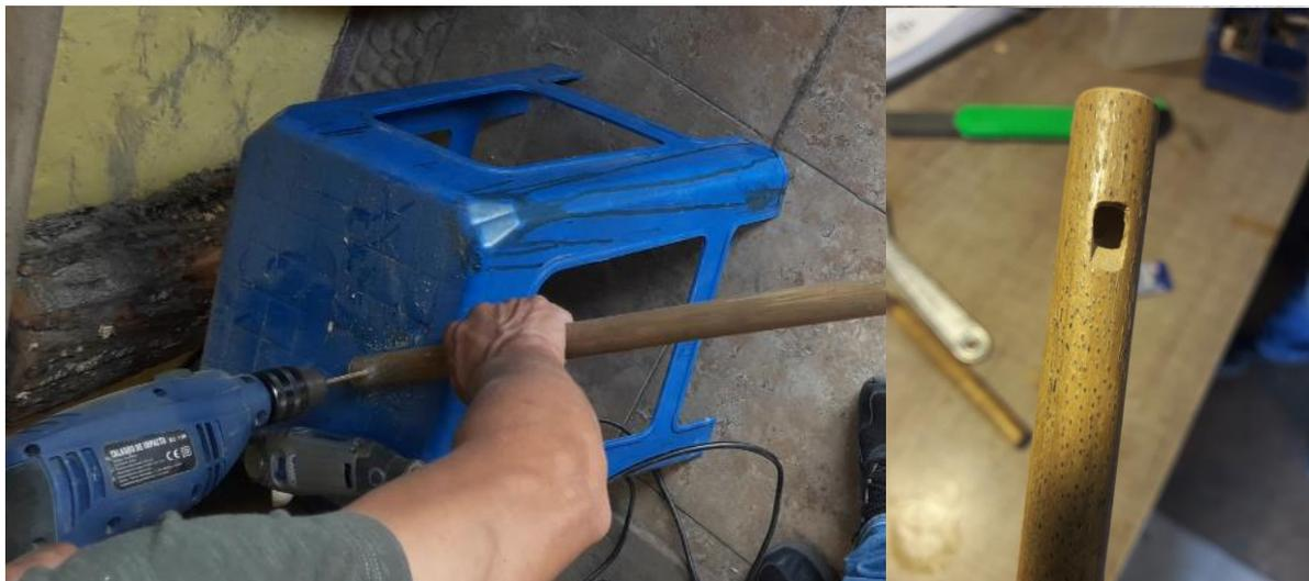
*Ilustración 57: Construcción de biseles en instrumentos del Pawkar Raymi*
