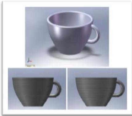
Figura 132: imagen de cada efecto de construcción con varios grosores de capas.
