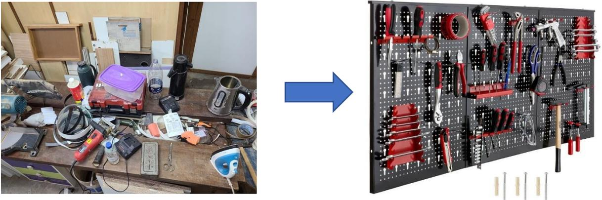
*Imagen 17: Tablero organizador de herramientas de acero perforado. Permite tener las herramientas organizadas y fuera de las superficies de trabajo. Contar con un tablero en cada área de trabajo con sus correspondientes herramientas permitirá ahorrar tiempo de traslado.*
