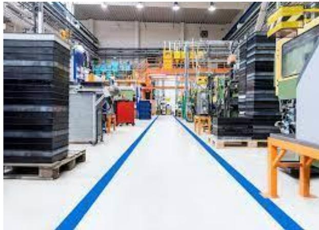
*Imagen 29: Ilustración de una correcta presentación de un pasillo en un taller.*
