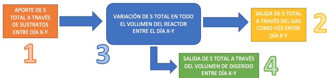
Ilustración 13: Esquema del comportamiento del S al ingresar al reactor, empleado para determinar el balance de masa.
