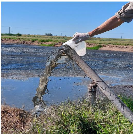
Figura 6 - Recolección de muestras en la descarga del líquido digerido en bidones de 5 litros.
