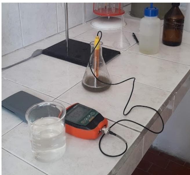
Figura 7 - Medición de pH de la muestra mediante pHmetro (INTA - Venado Tuerto, 2022).
