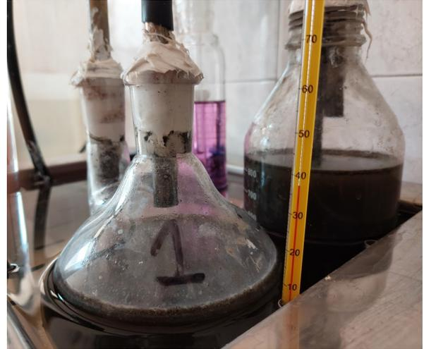
Figura 13 - Temperatura de funcionamiento del ensayo de producción de metano/biogás (INTA - Venado Tuerto, 2022).
