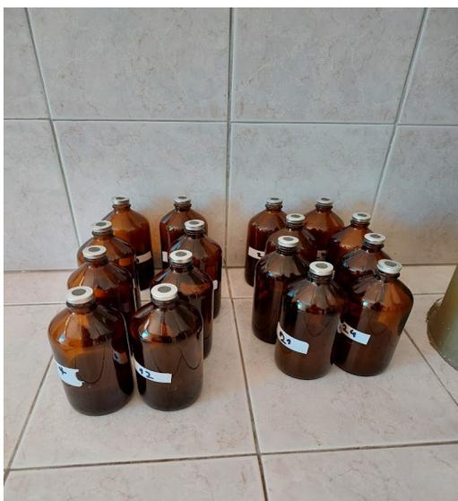
*Figura 9 - Frascos de vidrio color caramelo de 250ml con muestras de efluente del biodigestor (INTA - Venado Tuerto, 2022).*
