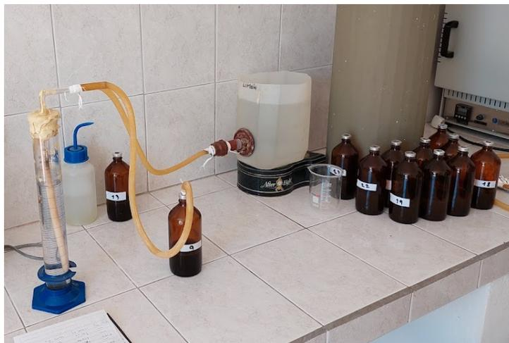
Figura 11 - Sistema de medición de producción de biogás mediante probeta y aguja (INTA - Venado Tuerto, 2022).
