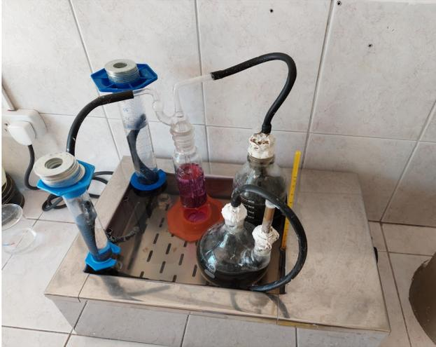
Figura 12 - Sistema de producción de biogás/metano en baño termostático (INTA - Venado Tuerto, 2022).
