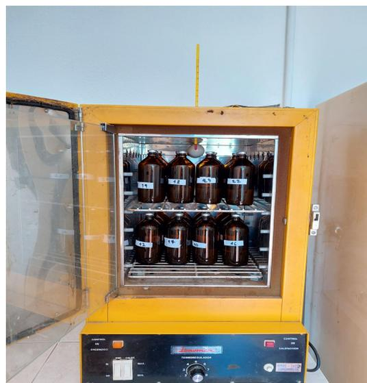
*Figura 10 - Estufa regulada a 35 °C, donde se alojan los frascos durante el ensayo (INTA - Venado Tuerto, 2022).*
