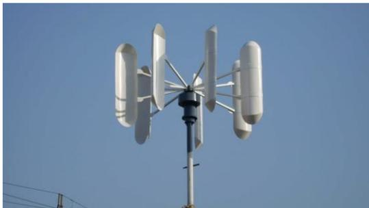
Se puede diferenciar a los aerogeneradores en dos grandes tipos: de eje vertical o de eje horizontal. Este tipo de aerogenerador, como se indica en la imagen, tienen la ventaja de no depender de la dirección del viento, ya que su eje es vertical va a girar lo mismo sin importar por donde golpea el viento. Otra ventaja es que los sistemas de generación y control son mucho más
